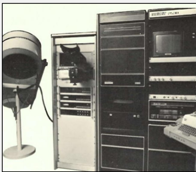
GE Radi gammakamera ja Nukab-tietokone. Tulostimena toimi Polaroid-kamera ja lämpökopioilaite.
