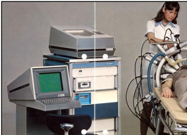
Valmet B1 1400. Fysikot Matti Koskinen, Jyrki Kuikka ja Antero Koivula kehittivät systeemille Basic-kieleen pohjautuvan analysointiohjelman. Tektronix-näytöltä kuvat voitiin kopioida mustavalkoiselle lämpöpaperi-tulostimelle, potilastutkimukset ja tietokoneohjelmat tallennettiin C-kasetille.
